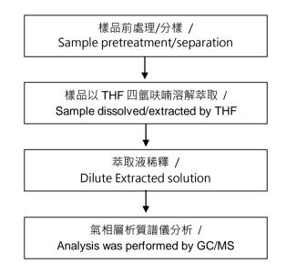
【測試方法/Test method: IEC 62321-8】
